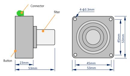
Connector ①+24V ②GND ③V-Out, ④A-Out ⑤RS-485(A) ⑥RS-485(B)
